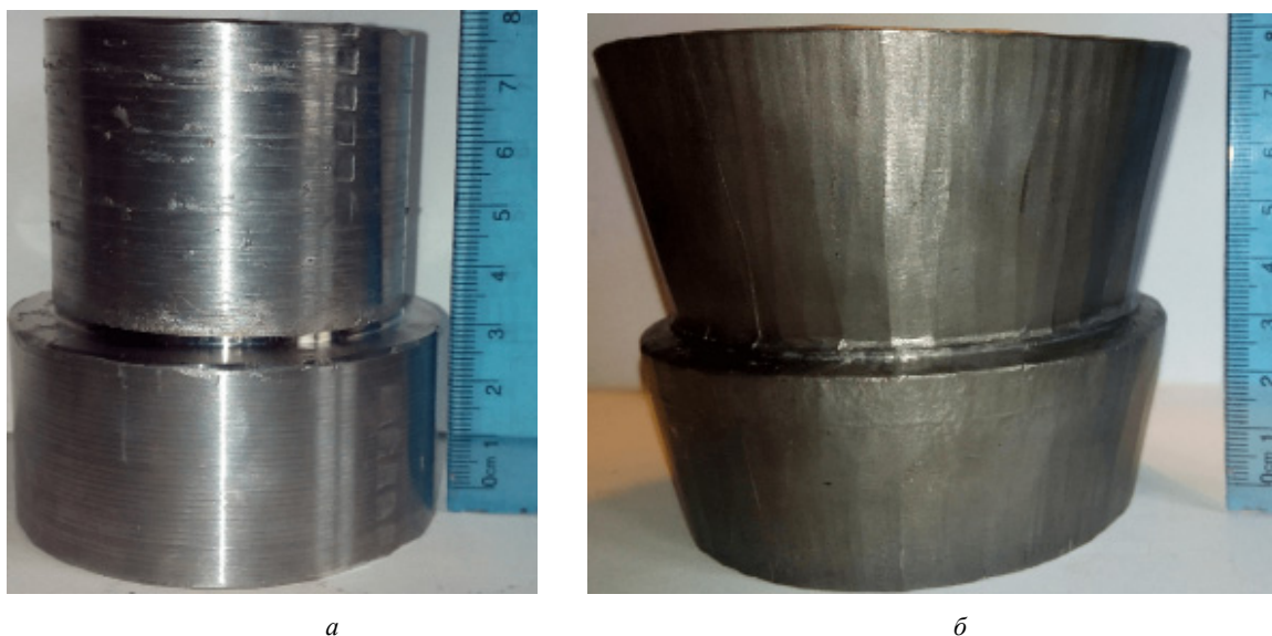
Рис. 6. Заготовка (а) та поковка (б) отримана після розкочування при ступені деформації 0,3
