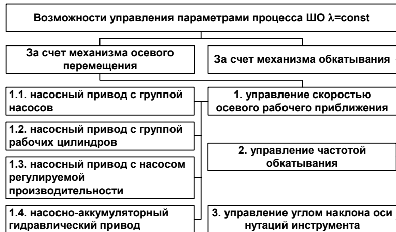
Рис. 2. Варианты возможного управления параметрами процесса ШО с заданным коэффициентом \lambda
