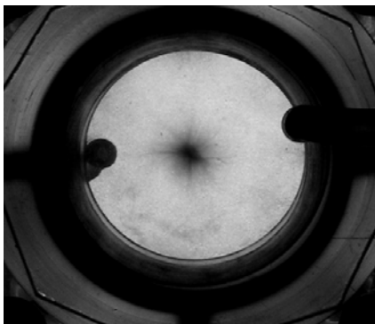
Рис. 5. Визуально наблюдаемый эффект концентрации ультразвуковой энергии в цилиндрической кавитационной камере, совершающей радиальные колебания различной интенсивности
