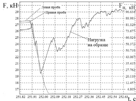
Рис. 4. Динамика перераспределения нагрузок в системе при динамическом неравновесном процессе. Левая шкала оси ординат (F, кН) соответствует нагрузке на образце, а правая (F п , кН) – нагрузке на пробе
