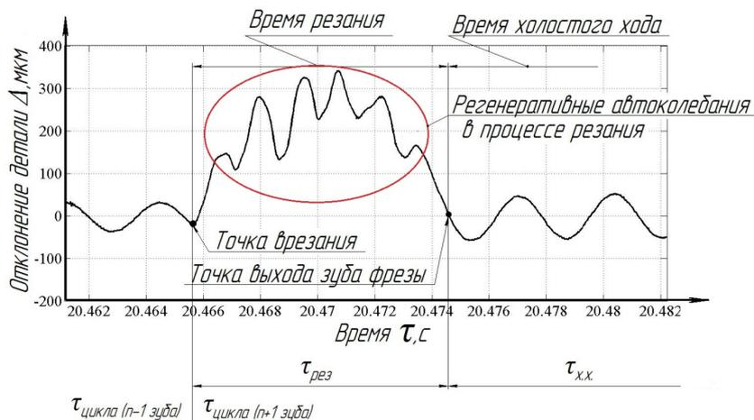
Рис. 6. Базовый фрагмент осциллограммы отклонения тонкостенной детали при фрезеровании с постоянной частотой вращения шпинделя
