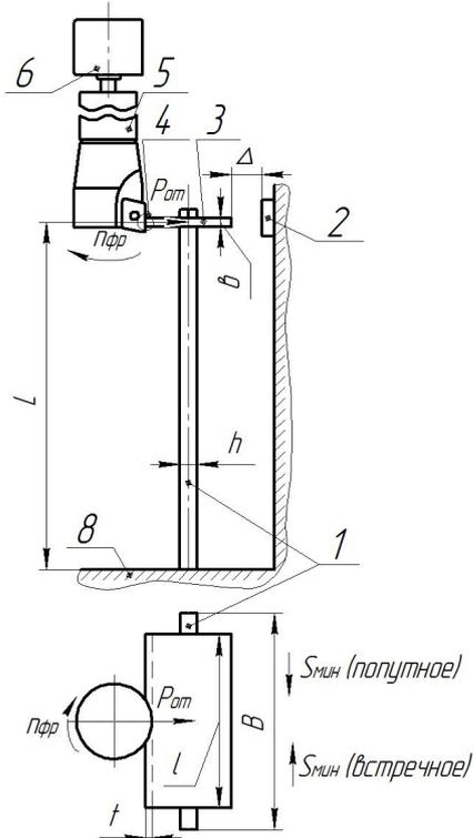
1 – УС тонкостенной детали (пластина размером  $L \times B \times h$ ); 2 – Датчик перемещения обрабатываемого образца; 3 – Обрабатываемый образец; 4 – Зона обработки фрезерованием; 5 – Концевая фреза; 6 – Счетчик оборотов; 8 – Приспособление для крепления пластины
