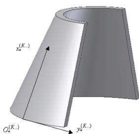
**Рис. 3. Продольное ( $O_*^{(K...)}x_*^{(K...)}$ ) и поперечное ( $O_*^{(K...)}y_*^{(K...)}$ ) направления оболочки отсека К... биконической секции**
