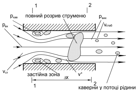
Рис. 3. Схема повного розриву струменю у циліндричному насадку
