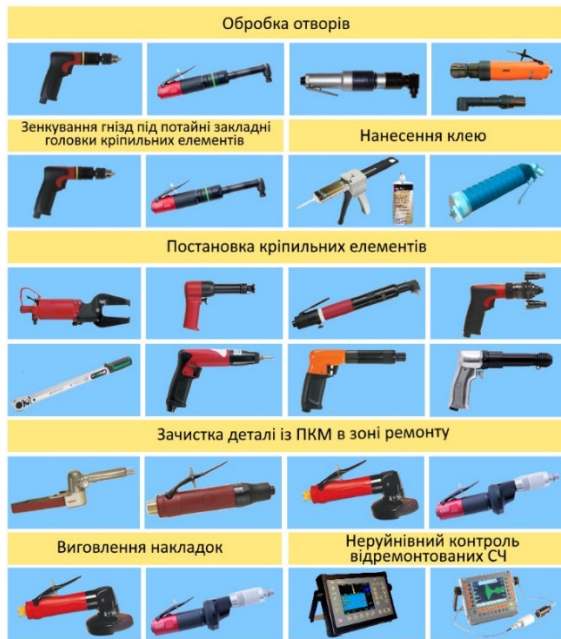
Рис. 5. Сучасні ЗТО для ремонту дефектів СЧ із ПКМ планера літака
