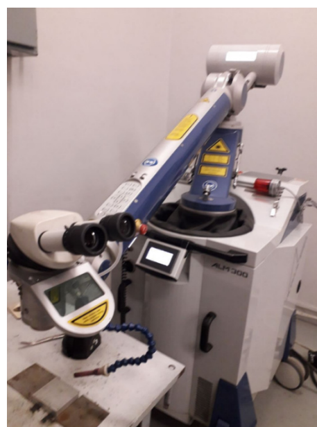
Рис. 5. Система ALM - 300 (ALPHA LASER GmbH) на базі твердотільного лазера (а) і її загальний вигляд з маніпулятором і системою фокусування (б): а – 1 – протизвага з дисплеєм параметрів лазера; 2 – рухомий лазерний модуль; 3 – підключення джойстика; 4 – клавіатура для керування параметрами лазера; 5 – рівень положення суглобу з лазерною головою; 6 – насадка для мікроскопу; 7 – підключення для додаткової осі обертання; 8 – сенсорний екран для управління системою руху; 9 – невидимий лазерний промінь; 10 – джойстик переміщення лазерної руки; 11 – зовнішній робочий блок; 12 – багатофункціональний ножний перемикач
