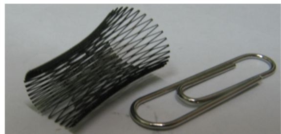
Рис. 12. Розгорнуті стенти (діаметр 12 мм, до розгортання діаметр – 4 мм, ширина перекриття 0,1 мм)
