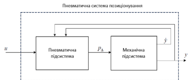
Рис. 6. Схема керування безштоковим циліндром з моделлю Люгре
