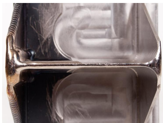
Рис. 2. Деталі виготовлені технологією “xBeam3D” [https://xbeam3d.com/xbeamtechnology/]
