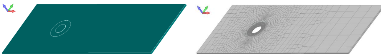
Рис. 3. Модельний зразок: половина товщини полоси з отвором, у який вставлено жорсткий штифт (“болт”)
