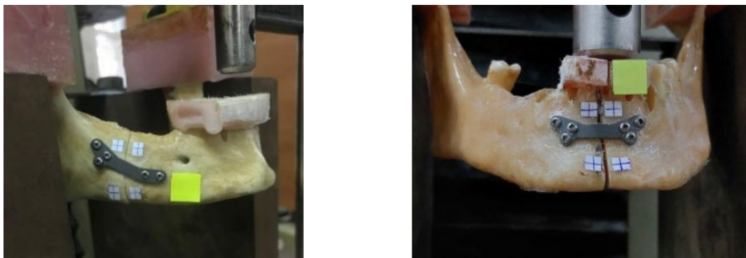
Рис. 11. Зафіксовані в навантажувальному механізмі НЩ із змодельованими різними типами переломів та фіксацією її фрагментів мініпластинами
