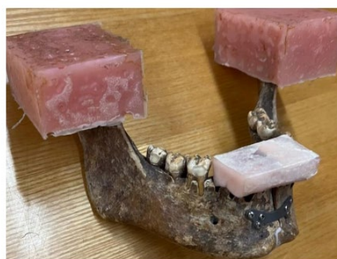
Рис. 10. Підготовлений для випробувань в універсальній машині TIRAtest-2151 (а) зріз металоостеосинтезу кісток НЩ ушкоджених переломом (б)
