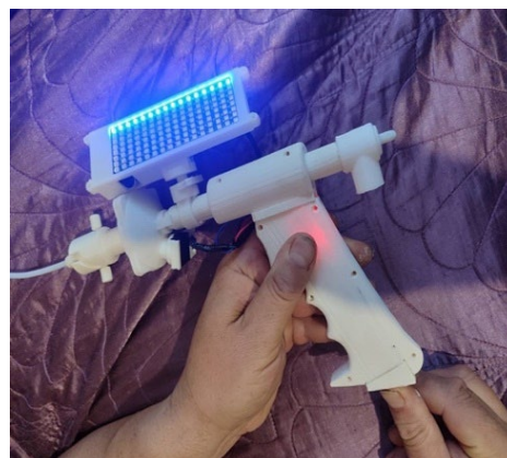
Рис. 9. Прилад для ревізії ранового каналу
