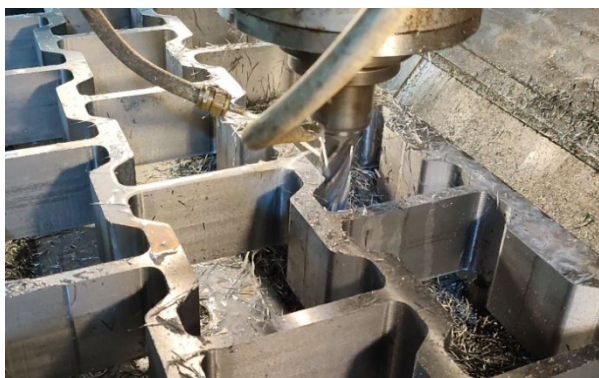
Рис. 3. Фрезерна обробка металоформ на верстаті з ЧПК
