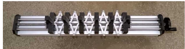
Рис. 3. Діючий макет механізму регулювання положення із рівномірною зміною кроку паралелограмного типу для 6-ти виконавчих вузлів
