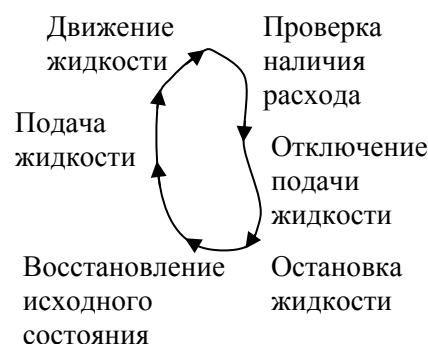
Рис. 5. Структура процесса тестирования обратного клапана в режиме 1
