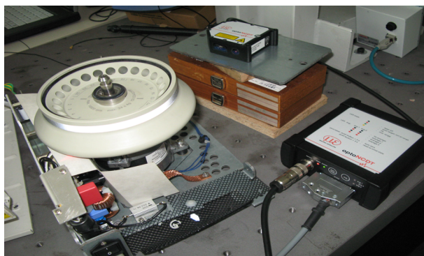
Рис. 7. Стенд та його схематичне зображення для експериментального визначення залежності власних частот від частоти обертання
