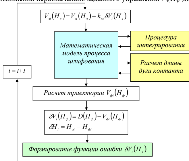
Рис. 6. Итерационный алгоритм решения вариационной задачи оптимального управления
