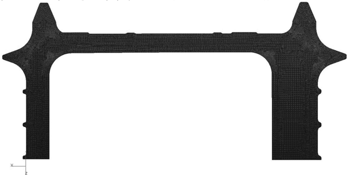
Рис. 4. Локальна СЕ-модель окантовки вантажного люка
