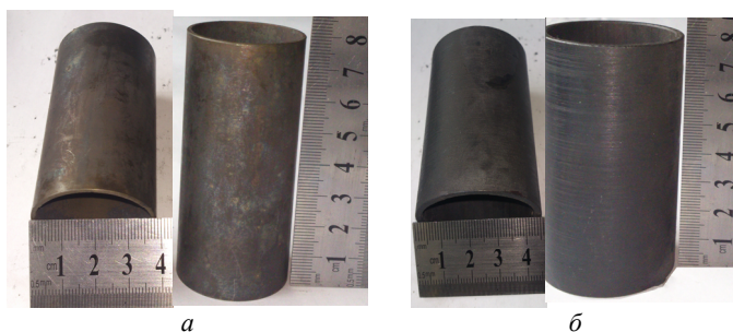
Рис. 7. Вихідні трубчасті заготовки: а – із сталі 12X18H10Т, б – із сталі 10
