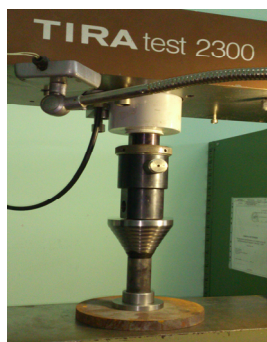
Рис. 6. Випробувальна машина TIRA test 2300 з встановленим експериментальним оснащенням
