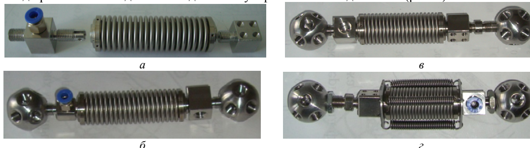
Рис. 5. Зовнішній вигляд пружно-деформованих сільфонних приводів: а – основні деталі привода; б – привод у зібраному стані без додаткового стиснення пружиною; в – привод із пружиною, розміщеною в порожнині сільфона; г – привод із трьома пружинами встановленими навколо сільфона
