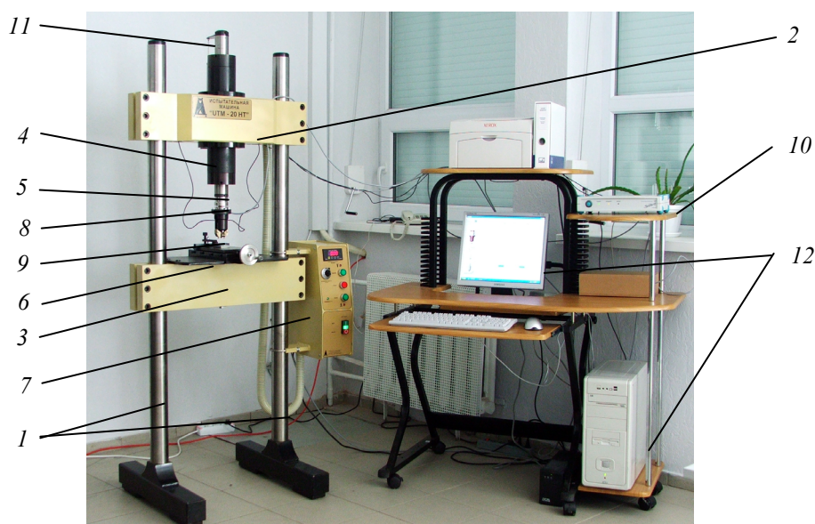
Рис. 2. Універсальна випробувальна машина для індування металів кулькою із твердого сплаву: 1 – колони, 2 і 3 – верхня і нижня траверси; 4 – пристій навантаження; 5 – шток, що передає навантаження; 6 – координатний столик; 7 – блок управління; 8 і 9 – датчики вимірювання навантаження і глибини вдавлювання індентора; 10 – АЦП перетворювач; 11 – датчик вимірювання положення штока навантаження; 12 – персональний комп'ютер
