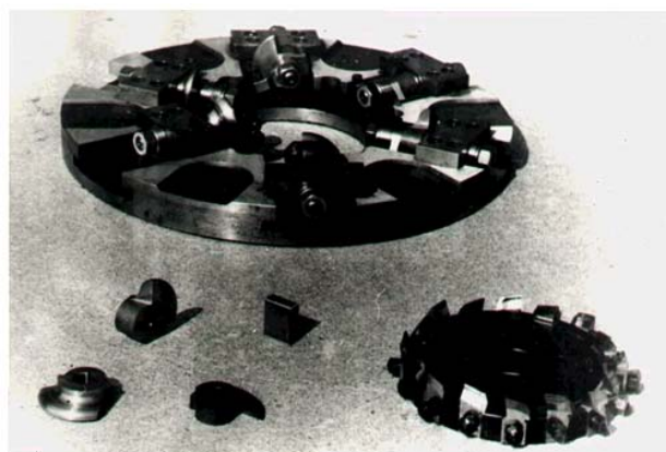
Рис. 9. Универсальные и специальные резцовые головки с круглыми незатылованными и призматическими резцами
