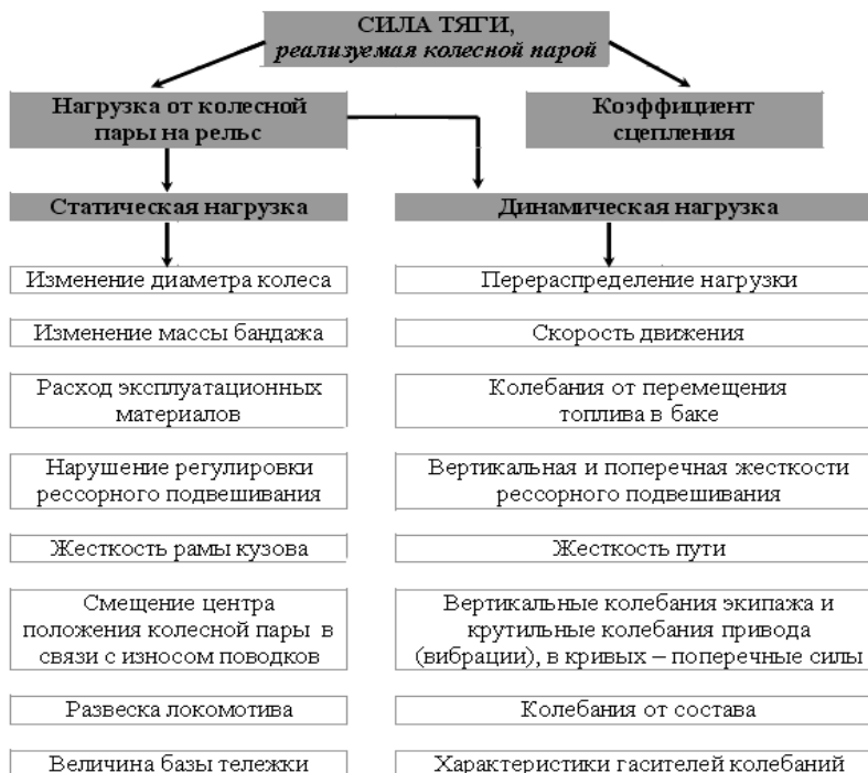
Рис. 1. Факторы, влияющие на реализуемую силу тяги
