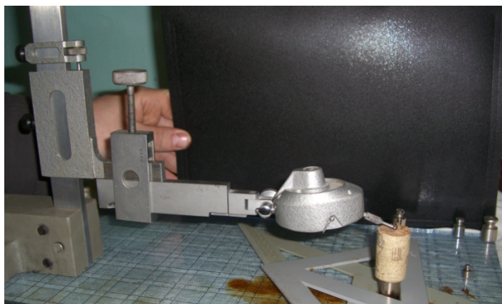
Рис. 4. Експериментальні виміри статичної силової характеристики магнітної опори з феромагнітною рідиною і циліндричним магнітом
