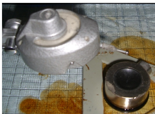
Рис. 6. Експериментальні виміри статичної характеристики магнітної опори з кільцевим магнітом: – встановлення індикатора для вимірів переміщення магніта (а); статична характеристика магнітної опори з кільцевим магнітом (б)
