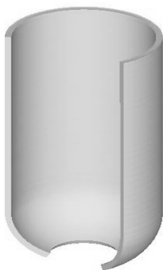
Рис. 7. Загальний вигляд виробу в розрізі після закритого обтиску
