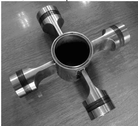
Рис. 1. Ультразвуковой кавитатор резонансного типа
