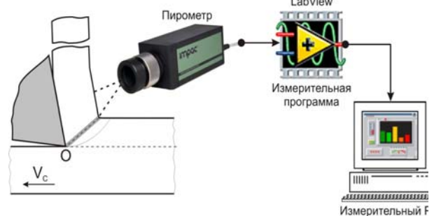
Рис. 5. Пиктограмма измерительной схемы температуры стружки при резании
