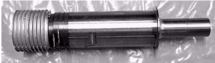
Рис. 4. УЗ-випромінювач з однохвилевою акустичною системою і ступінчастим трансформатором швидкості
