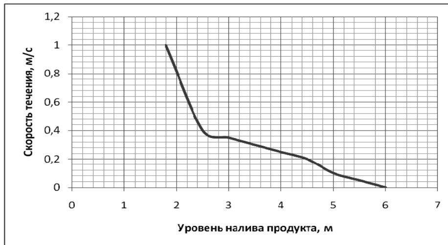
Рис. 3. Зависимость скоростей течения в горизонтальном направлении от высоты налива продукта
