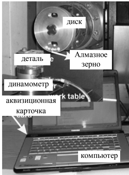
Рис. 3. Установка для измерения сил микрорезания
