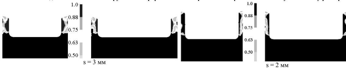
Рис. 16. Розподіл ступеню використання ресурсу пластичності \psi в перерізах по вісі коробчатих виробів по меншому і більшому розмірах
