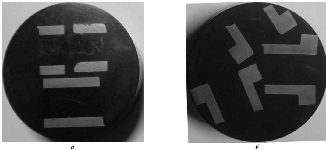
Рис. 5. Запрессованные в бакелит образцы: а – недеформированная область; б – деформированный участок
