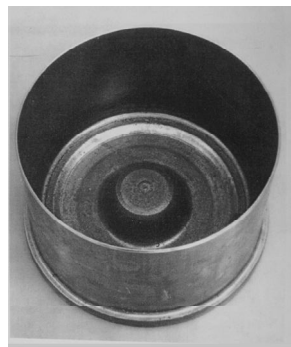
Рис. 3. Сталевий піддон, отриманий витяжкою з попередньо спрофільованої заготовки
