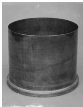
Рис. 3. Сталевий піддон, отриманий витяжкою з попередньо спрофільованої заготовки
