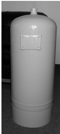
Рис. 4. Штампований балон з одним кільцевим швом
