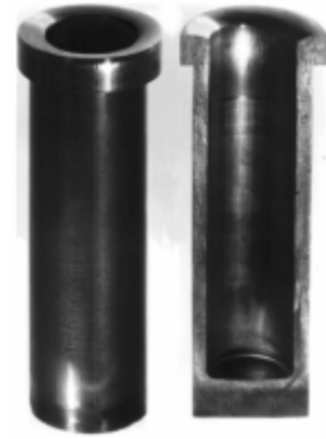
Рис. 11. Штмп для видавлювання з розтягом на пресі зусиллям 4 МН та деталі, які отримані в штампі
