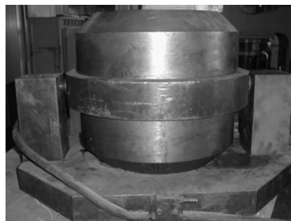
Рис. 3. Виробничий штамп та контейнери різного діаметра для холодного видавлювання порожнин з малопластичних сталей
