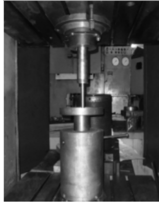
Рис. 11. Штмп для видавлювання з розтягом на пресі зусиллям 4 МН та деталі, які отримані в штампі
