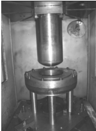
Рис. 12. Штмп для витягування, який встановлений на гідравлічному пресі ДБ2432 зусиллям 1,6 МН
