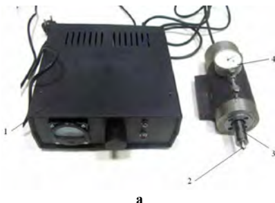
Рис.7. Ультразвукова установка (а) та креслення головки для вигладжування (б)
