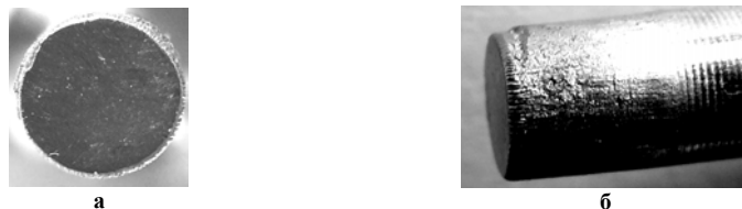
Рис.6. Зношування та руйнування пробивного пуансона (збільшення в 10 разів): по торцю - а) та по боковій поверхні - б)
