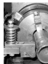
Рис. 5. Фотографії технологічних процесів: ЕІЛ - а) та обкочування кулькою - б)
