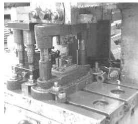
Рис.4. Фотографії установки для дослідження зношування ріжучих кромки (а) та ножа без зміцнення після випробувань (б): 1 отвір - 8 тис. штампоударів; 2 отвір - 10 тис. штампоударів
