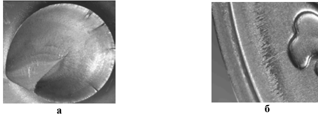
Рис.7. Руйнування карбувального штемпеля в поперечному напрямку зони галтельного переходу - а) та тріщини на робочій поверхні - б)
