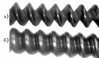
Рис.5. Фотографія оправки а) та зразка б) з кроком гвинта 20 мм
