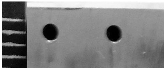
Рис. 9. Фотографія робочої бічної поверхні нижнього нерухомого ножа з покриттям нітридом хрому: 1-ий отвір (зліва) – 20 тис. штампоударів ( h=0,16 мм), 2-ий отвір (зправа) – 18 тис. штампоударів ( h=0,09 мм)
