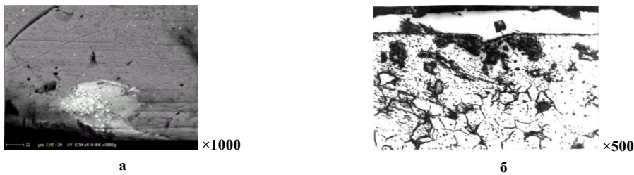
Рис.1 Структурні зміни поверхневого шару при електроіскровому легуванні високовуглецевої сталі (а) та маловуглецевої сталі (б)
