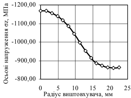
Рис. 5. Розподіл осевих напружень \sigma_z на виштовхувачі
