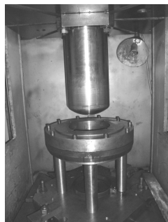
Рис. 12. Штмп для витягування, який встановлений на гідравлічному пресі ДБ2432 зусиллям 1,6 МН
