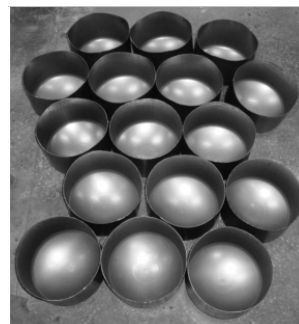
Рис. 13. Заготовки з маловуглецевої сталі, які отримані витягуванням
