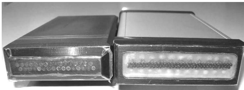
Bild 8. Wirbelstromsensorzeilen. Links: 32 Elemente, Breite 45 mm, rechts: 64 Elemente, Breite 61 mm
