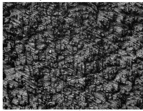
Рис. 13. Структура металу в зоні пера лопатки
