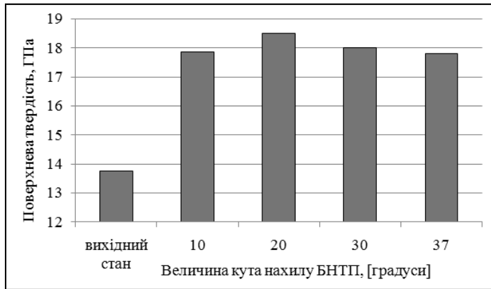
Рис. 7. Зміна середньої величини поверхневої твердості HV_{200} залежно від кута нахилу БНТП фірми SANDVIK під час MAO
