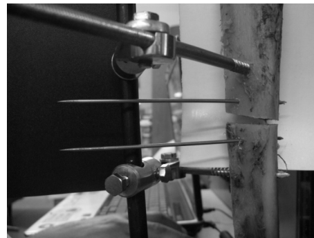
Рис. 10. Фрагмент ВГК з переломом у випробуваннях на стиск
