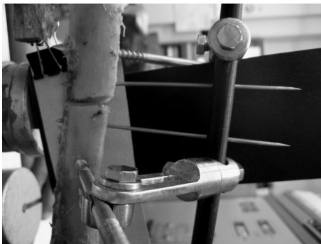
Рис. 9. Фрагмент ВГК з переломом у випробуваннях на згин
