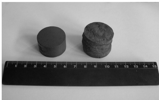
Рис. 2. Внешний вид образца до спекания (слева) и после спекания (справа) при 1200 °С
