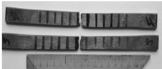
Рис. 4. Образцы после испытаний на растяжение
