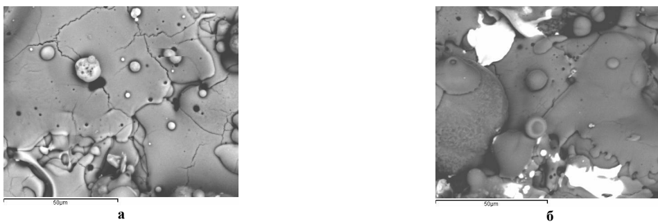
Рис.8. Электронное изображение поверхности плазменного покрытия: а) на основе чистого (не плакированного) оксида алюминия, б) на основе плакированного оксида алюминия двухслойными оболочками титана и меди (x 1000)
